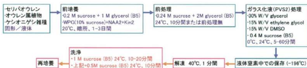
図1. ガラス化法による超低温保存の手順
