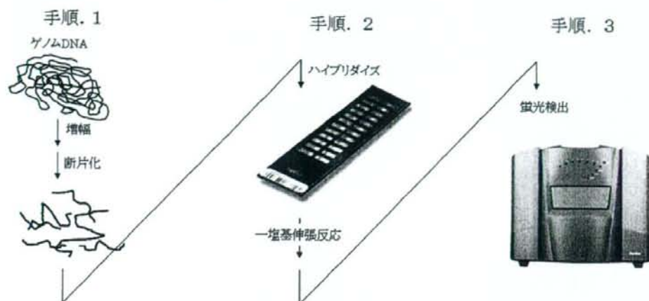
図 9.3 BeadChip の実験手順。イルミナ社ウェブサイトより抜粋・改変
