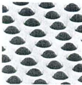
図 9.1 BeadChip のマイクロウェルの拡大図。 イルミナ社ウェブサイトから抜粋・引用
