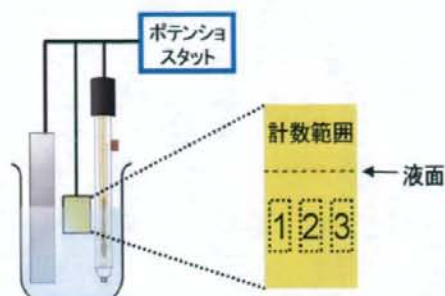
Fig. 3 三電極系とチップ計数範囲
