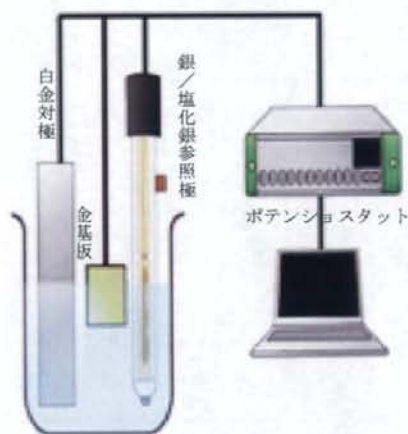
Fig. 2 三電極系および電気化学測定装置
