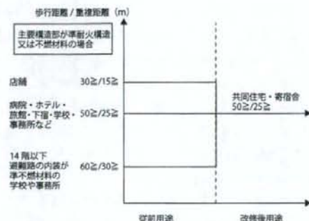
図9 用途別の歩行距離/重複距離規定 (建築基準法)
