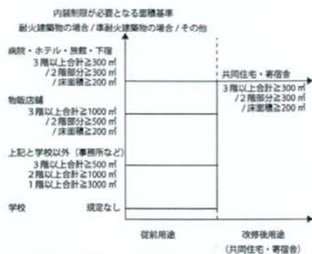
図13 用途別の内装制限の規定(建築基準法)
