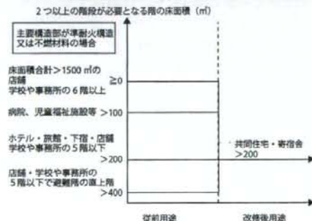
図8 用途別の2つ以上の直通階段の規定 (建築基準法)
