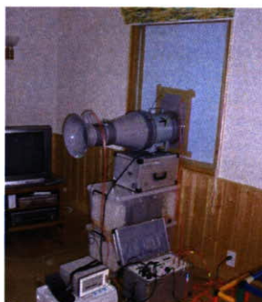
写真5 気密測定の様子
