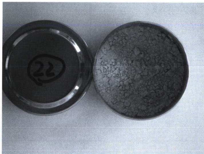
写真1 フタル酸ジエチルヘキシルを添加したセメントとステンレス製保存容器
