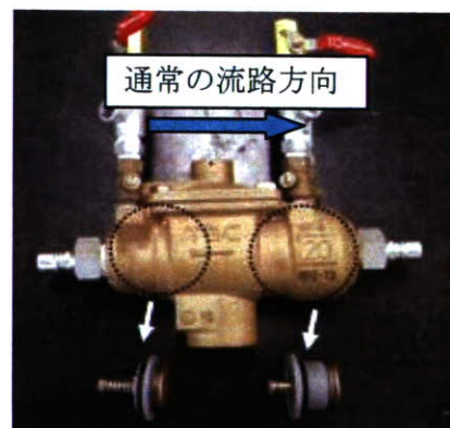
図 4 市販の口径 20mm の減圧式逆流防止器
