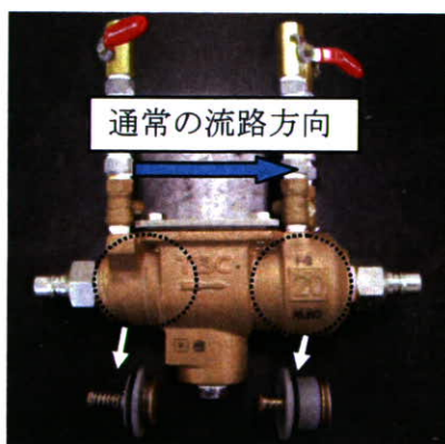
図 3 市販の口径 20mm の二重式逆止弁
