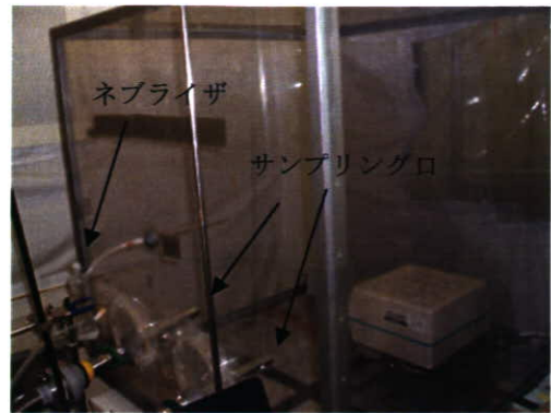
写真-3-2 ゼラチンフィルタによる C. cladosporioides 孢子の捕集実験装置
