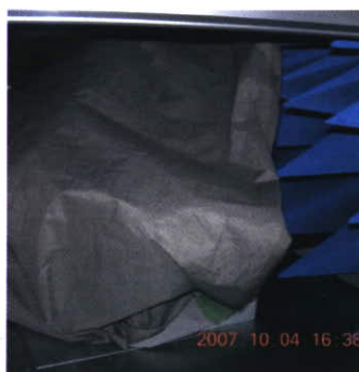
遮蔽布で遮蔽 (パッドと遮蔽布が接触しないようビニールのエアキャップを挿入している。)
