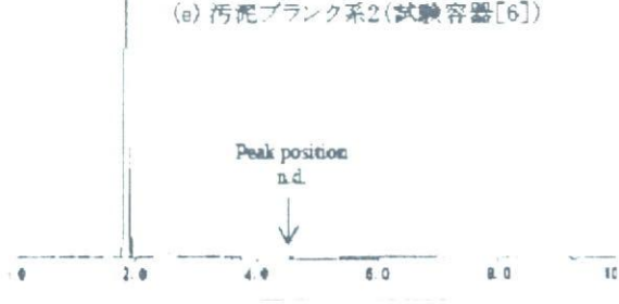
図 3 HPLC による被験物質分析:(水+被験物質)系、(汚泥+被験物質)系共に被験物質はほぼ理論量残留し、HPLC クロマトグラム上に被験物質以外のピークは認められなかった。
