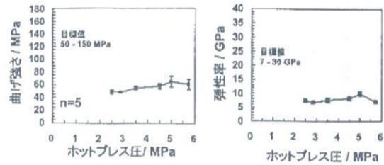
図4 種々の圧力でホットプレス成形したHDPE/TiO<sub>2</sub> 複合体の曲げ強度および弾性率
