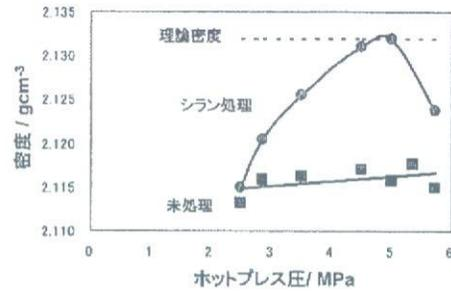
図5 種々の圧力でホットプレス成形したHDPE/TiO<sub>2</sub> 複合体の密度
