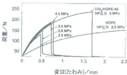
図3 種々の圧力でホットプレス成形したHDPE/TiO<sub>2</sub> 複合体の荷重-変位曲線
