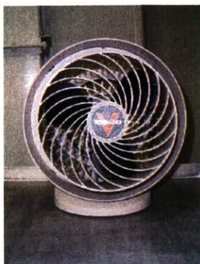
Photo. 3 チャンバー内空気攪拌用サーキュレーター(ボルネード)及び暴露ケージ(柴田科学)を載せた架台
