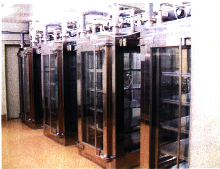
Photo. 1 3m 3 横層流大型チャンバー及びその発生装置(柴田科学)
