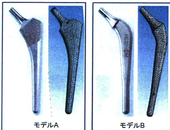
図2. 人工股関節ステムと有限要素モデル
