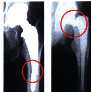
遠位部 ネック部 図1. ステムの破損例
