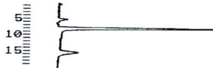
図1 Inertsil AX および TSK-GEL DEAE-5PW による C1/C2 の分離 (4mM ヘプタンスルホン酸、2%アセトニトリルを含むリン酸緩衝液を移動相とした)
