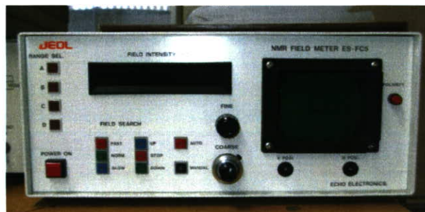
写真 7-16 NMR Field meter
