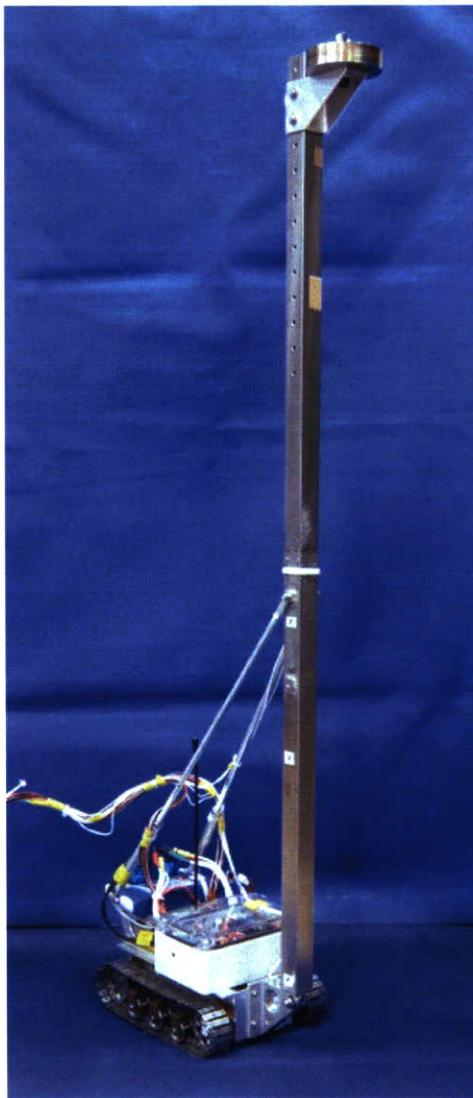
写真 4-2-6 杭打ち機械模型
