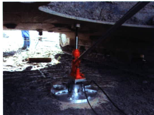
写真3-4-2 簡易式平板載荷試験
