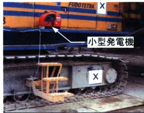
写真 3-5-6 車載した小型発電機
