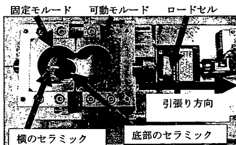
図2. 新開発引張り及びサクシジョン測定装置
