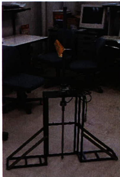
④上部に载荷軸を取り付けてコーンを設置して完成
