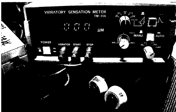
写真3 TM31定量振動覚計
