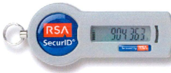
【図 5-12 ハードウェアトークンを用いたワンタイムパスワードの生成】
