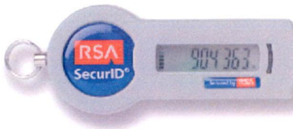
【図 5-12 ハードウェアトークンを用いたワンタイムパスワードの生成】
