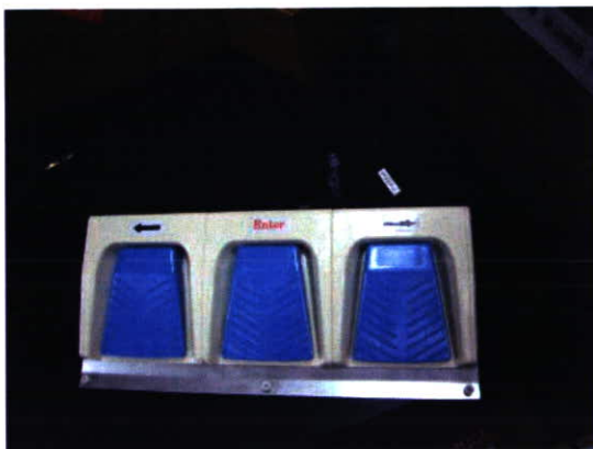
写真：3連フットスイッチ装置
