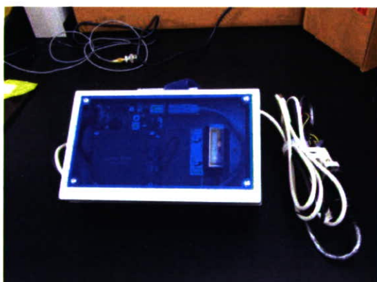
写真：ICタグリーダ・バーコードリーダー一体型装置
