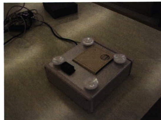
写真：ICタグリーダー・バーコードリーダー一体型装置 試作機 外面
