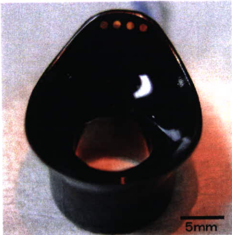
図1 経強膜刺激用コンタクトレンズ型電極。刺激電極数は4極。電極中心間距離は1.5mm。電極直径は1mm。
