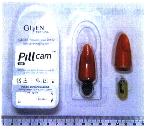
図1 小腸用カプセル内視鏡 PillCam™SB (26×11 mm, Given® Imaging Ltd.)
