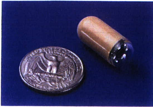
図 1 小腸用カプセル内視鏡(11×26 mm, PillCam™SB, Given Imaging, イスラエル)
