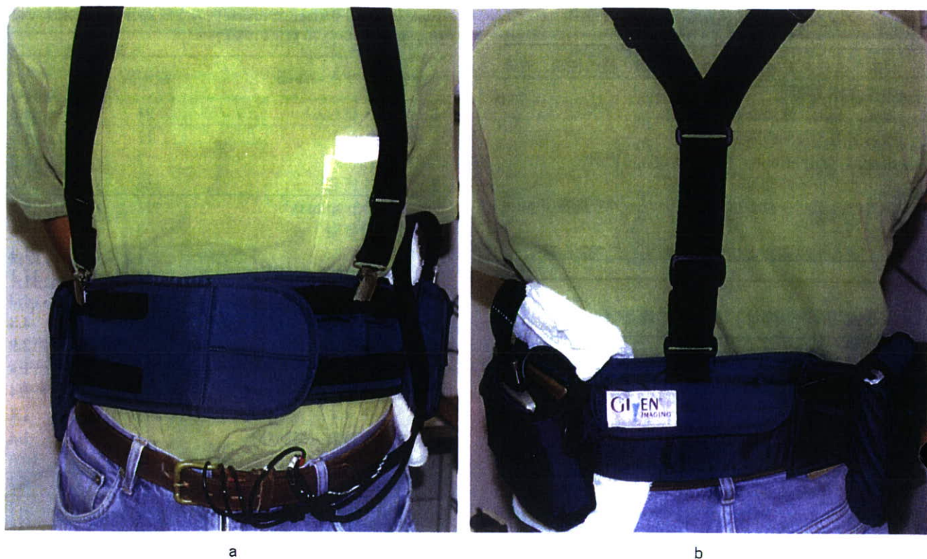
Figure 3 体外バッテリーとデータレコーダの装着図。 a. 正面図 (ベルトの上から出たセンサアレイのコードをデータレコーダに接続) b. 背面図 (向かって左がデータレコーダ)
