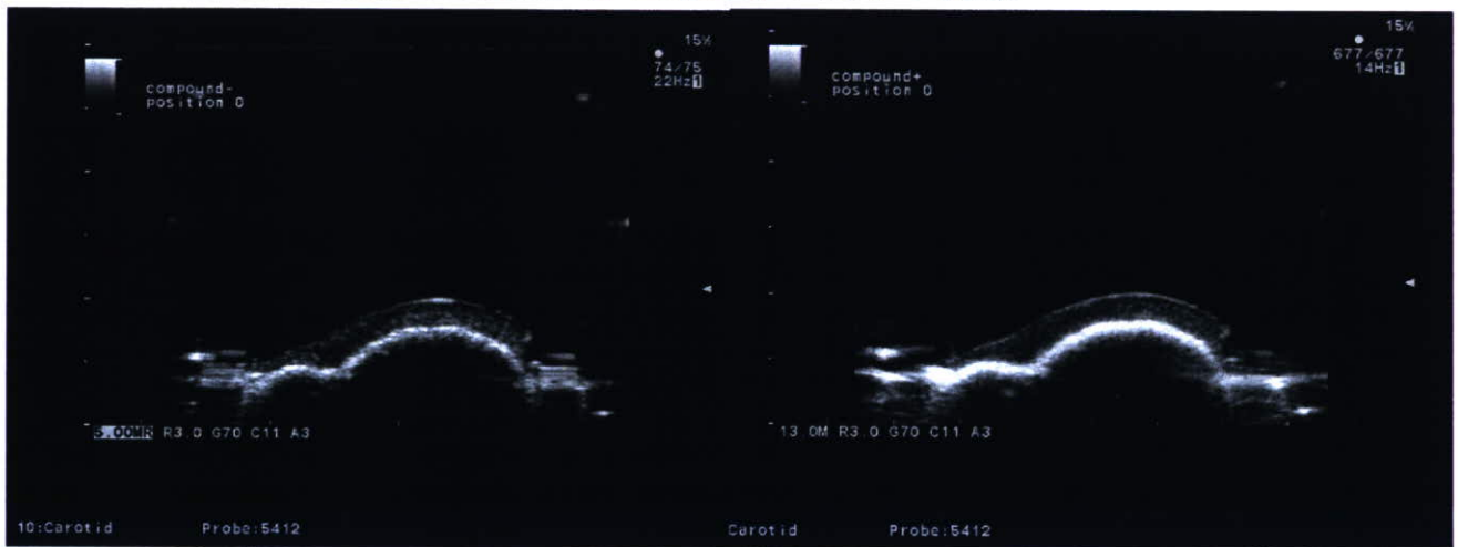
図4 関節軟骨超音波 B-mode 画像 (左 : Tissue Harmonic 使用、右 : 空間コンパウンド使用)
