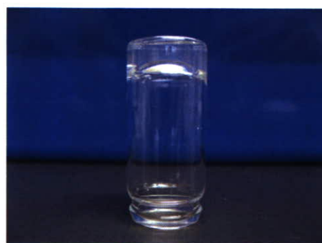
図 2. PMBV-AIBN 水溶液(5 wt%)と PVA1000 水溶液(5 wt%)の等量混合により得られた MPC ポリマーゲル
