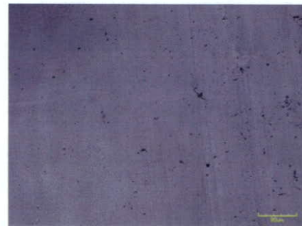
図 17-B. 500 万回後、未処理 CLPE 摺動部表面の LSM 写真
