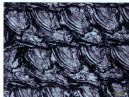
図 17-C. 試験前、PMPC 処理 CLPE 摺動部表面の LSM 写真
