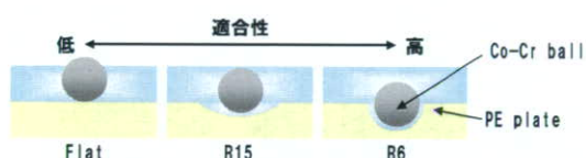
図 4. 摺動面の適合を変化させた Ball-on-plate の模式図
