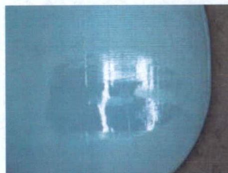
図 15-B. シミュレーション試験 100 万回後の CLPE インサート摺動部表面写真 (外顆側)
