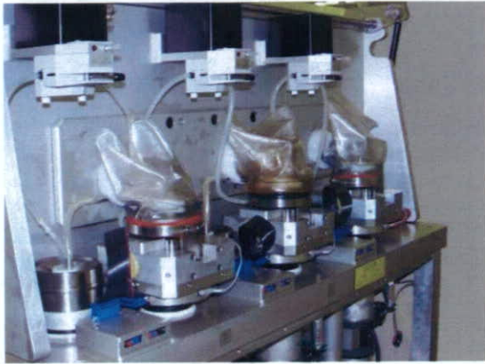
図 6. AMTI 社製 6 チャンネル人工膝関節シミュレーション試験装置
