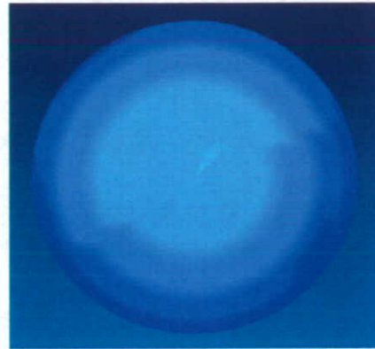
図 12-G. シミュレーション試験 3000 万回後の PMPC 処理 CLPE ライナー摺動面カウンター図
