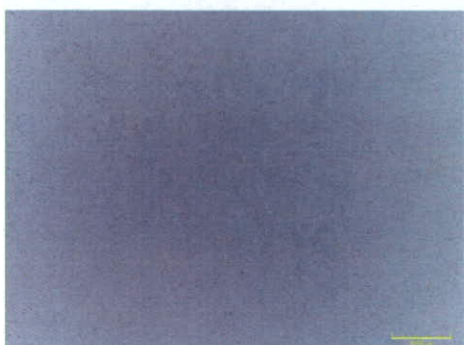
図 8-C. シミュレーション試験 1200 万回後の CLPE ライナー摺動表面 LSM 像
