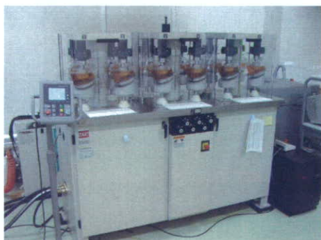
図 1. MTS 社製人工股関節シミュレーション試験機
