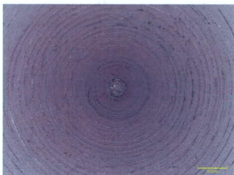
図 8-A. シミュレーション試験前の CLPE ライナー摺動表面 LSM 像
