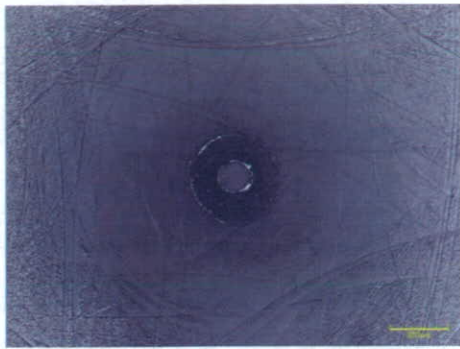
図 9-D. シミュレーション試験 1500 万回後の PMPC 処理 CLPE ライナー摺動表面 LSM 像
