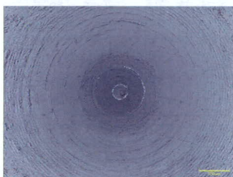
図 9-B. シミュレーション試験 500 万回後の PMPC 処理 CLPE ライナー摺動表面 LSM 像
