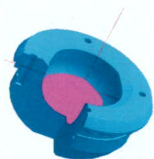
図 3-b マスキングライナー： 骨頭が接触する天頂部のみ MPC ポリマー処理した
