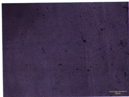
図 12-B. 500 万回後、未処理 CLPE 摺動部表面の LSM 写真
