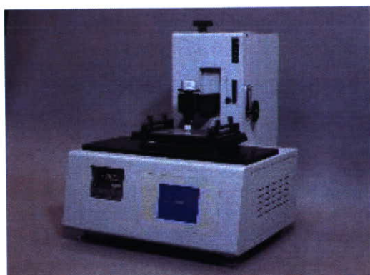
図 4. 新東科学製 Ball-on-plate 摩擦試験機
