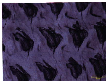
図 12-D. 500 万回後、PMPC 処理 CLPE 摺動部表面の LSM 写真
