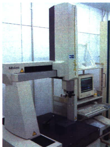
図 4. ミットヨ製 CNC3 次元測定器
