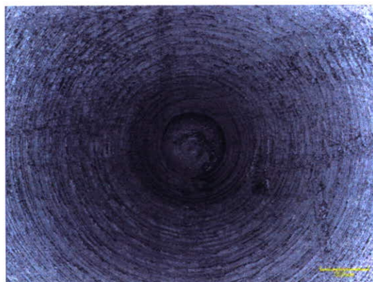
図 8. 人工股関節シミュレーション試験前の PMPC 処理 CLPE ライナー摺動表面 LSM 像
