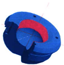
図 1-b 逆マスキングライナー： 骨頭が接触しない辺縁部の み MPC 処理した
