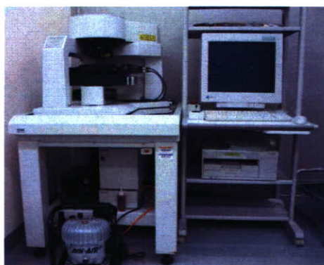
図 2. 走査型共焦点レーザー顕微鏡
