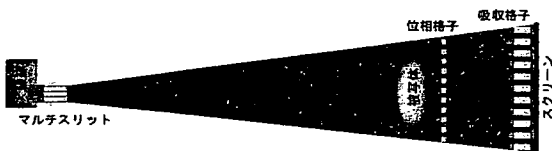
図4：X線タルボ・ロー干渉計による位相イメージングの構成
