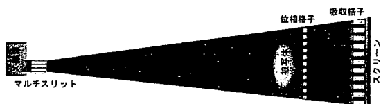
図1 X線タルボ・ロー干渉計による位相イメージングの構成。
