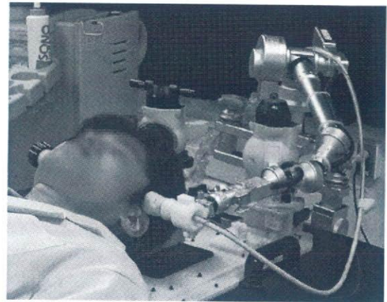
図23.ポイントセッターによるプローブの固定
