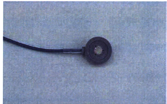
Fig.6 (a) 小型Ag-AgCl電極 ( \phi 3)
