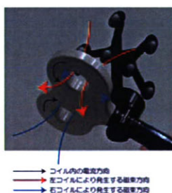
図 2 コイルに流れる電流と発生する磁束方向
