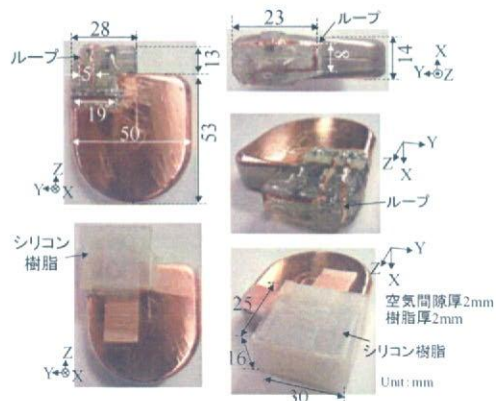
図 C-2-10 ICD に搭載したループ構成(i)
