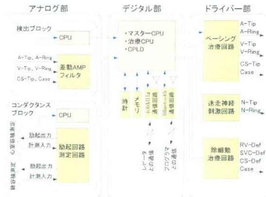
図4 ICD本体のシステム構成
