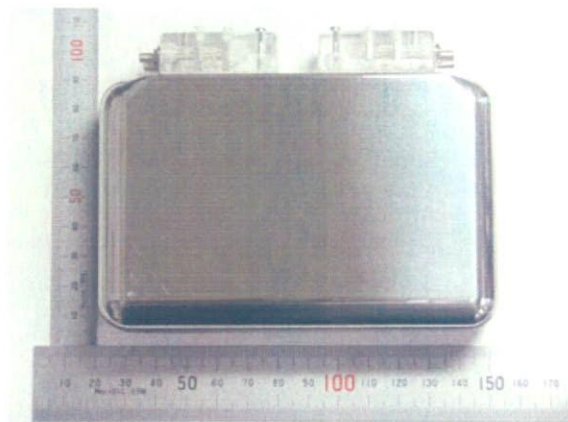
図 27 SUS ケースによる小型化
