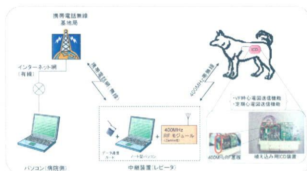
図 15 レピータ通信の全体像
