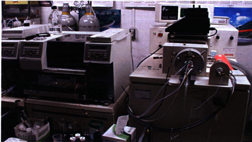
Fig. 5-02 エレクトロスプレーイオン化トリプルステージ四重極質量分析計 (ESI-TSQ) フィニガン・マット社 SSQ 7000
