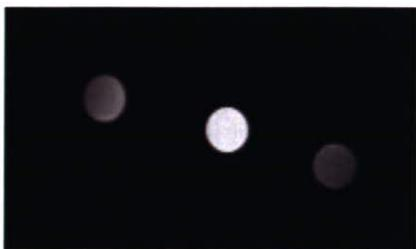
図21 MRI ファントム画像 (左)Gd-DTPA, (中央) ブロックコポリマー, (右)高分子ミセル(ブロックコポリマー+ポリアリルアミン). Gdイオン濃度=0.25mM.
