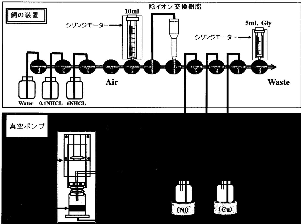
Fig. 10: カラム法を用いた  $^{64}\text{Cu}$  自動精製装置の概要図
