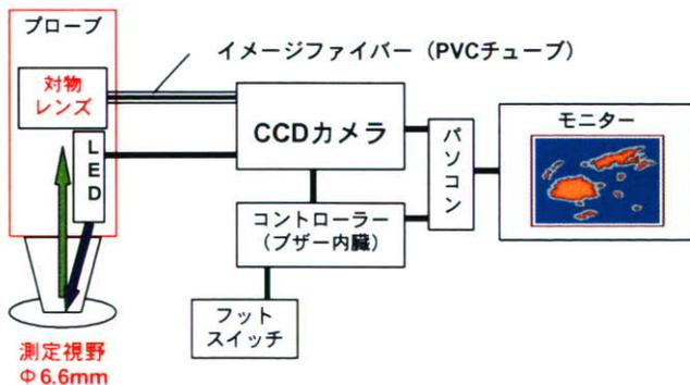
図3a 第3号試作機のシステム図
