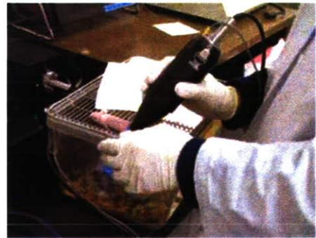
図3b プローブ先端と柔軟なファイバー
