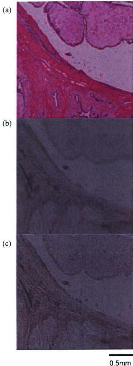
図 43 乳腺組織の(a)光学顕微鏡像、(b)超音波顕微鏡元画像、(c)超音波顕微鏡画質改善画像
