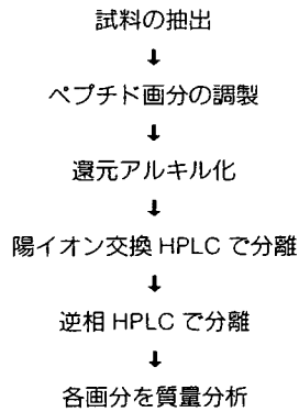
図② ペプチドミクスを用いる発現解析の流れ (筆者作成)
