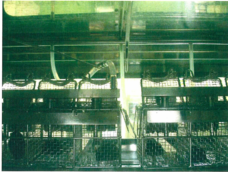
チャンバー内の動物ケージと濃度測定用の捕集管
