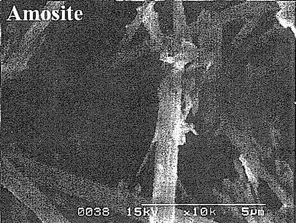
図 BN 及びアスベスト類の光学顕微鏡像及び SEM 像
