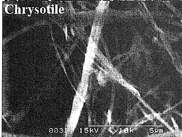
図 BN 及びアスベスト類の光学顕微鏡像及び SEM 像
