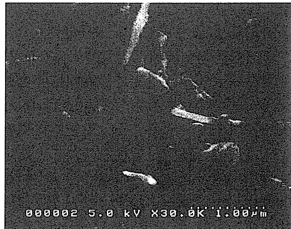
図4 BN 及びアスベスト類の光学顕微鏡像及び SEM 像
