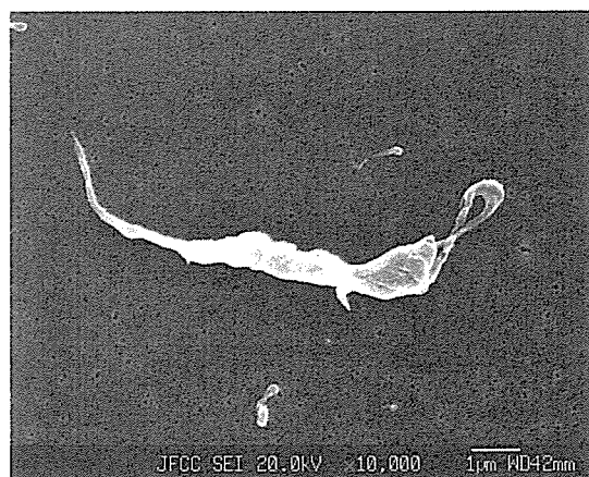
図5 UHMWPE ライナーから発生した摩耗粉 (試験回数 50 万回)
